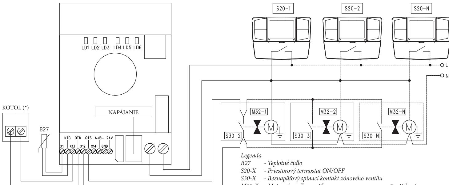
(\*) Pripojte Wi-Fi modul ku svorkám kotla, ktoré sú určené pre pripojenie riadiacej jednotky CAR<sup>V2</sup> označené ako 40, 41 alebo 41, 44 (podľa návodu k príslušnému kotlu).
