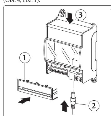
Potom čo zapnete napájanie kotla a Wi-Fi modulu (Obr. 4, Poz. 2) počkajte cca 30 sekúnd, aby mohla prebehnuť úvodná komunikácia medzi Wi-Fi modulom a kotlom.
